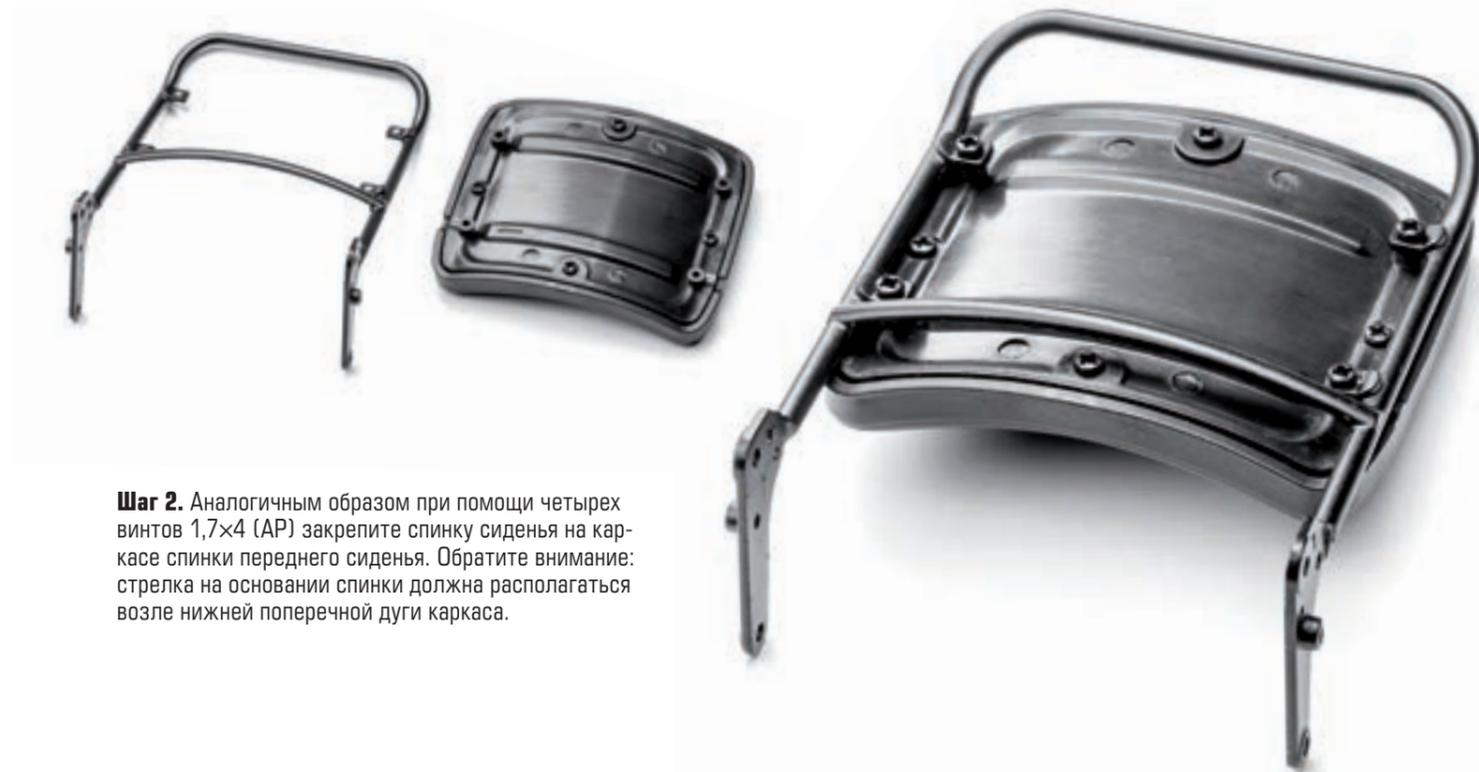
**Шаг 2.** Аналогичным образом при помощи четырех винтов 1,7×4 (АР) закрепите спинку сиденья на каркасе спинки переднего сиденья. Обратите внимание: стрелка на основании спинки должна располагаться возле нижней поперечной дуги каркаса.
